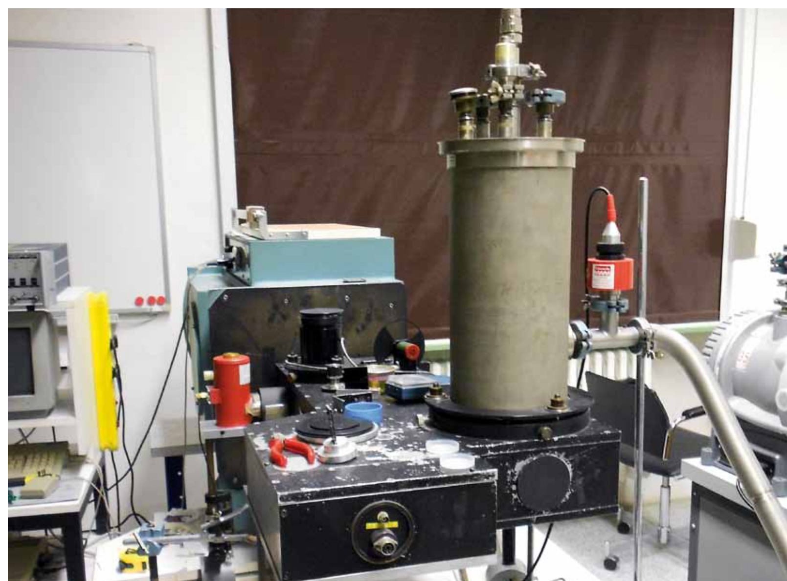
aparatura na měření emisních spekter luminiscence v IR oblasti
