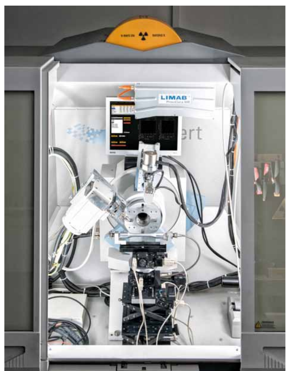
difraktometr s vysoce účinným pozičně citlivým detektorem
